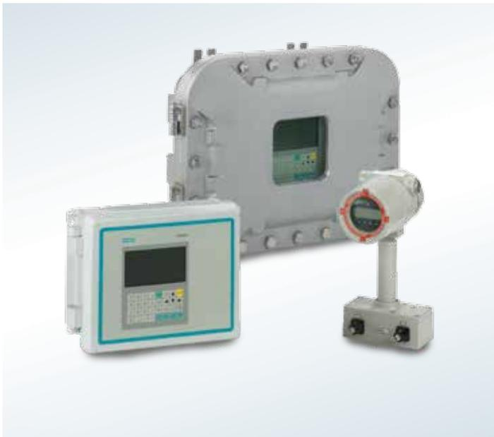
Al igual que con el resto de caudalímetros exteriores de Siemens, no es necesario cortar la tubería ni detener el funcionamiento para instalar el detector de interfaces. Los sensores se montan de forma rápida y fácil en el exterior de la tubería y se minimizan los gastos de mantenimiento, a la vez que se evita la formación de sedimentos.
